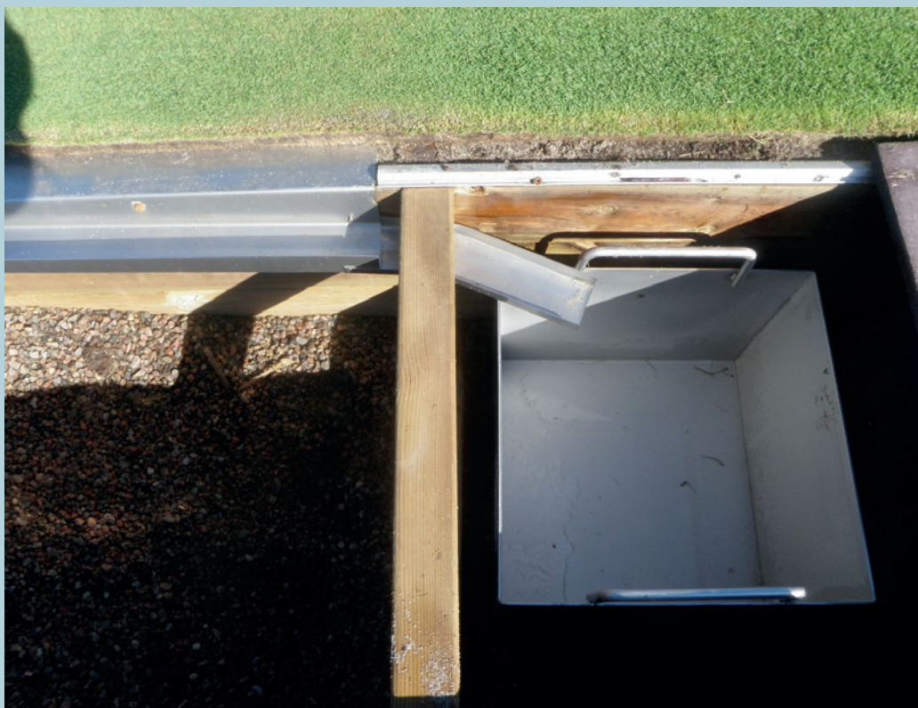
◀ Anlægget til opsamling af afstrømmet overfladevand fra de forskellige forsøgsparceller. Foto: Trygve S.Aamlid.
