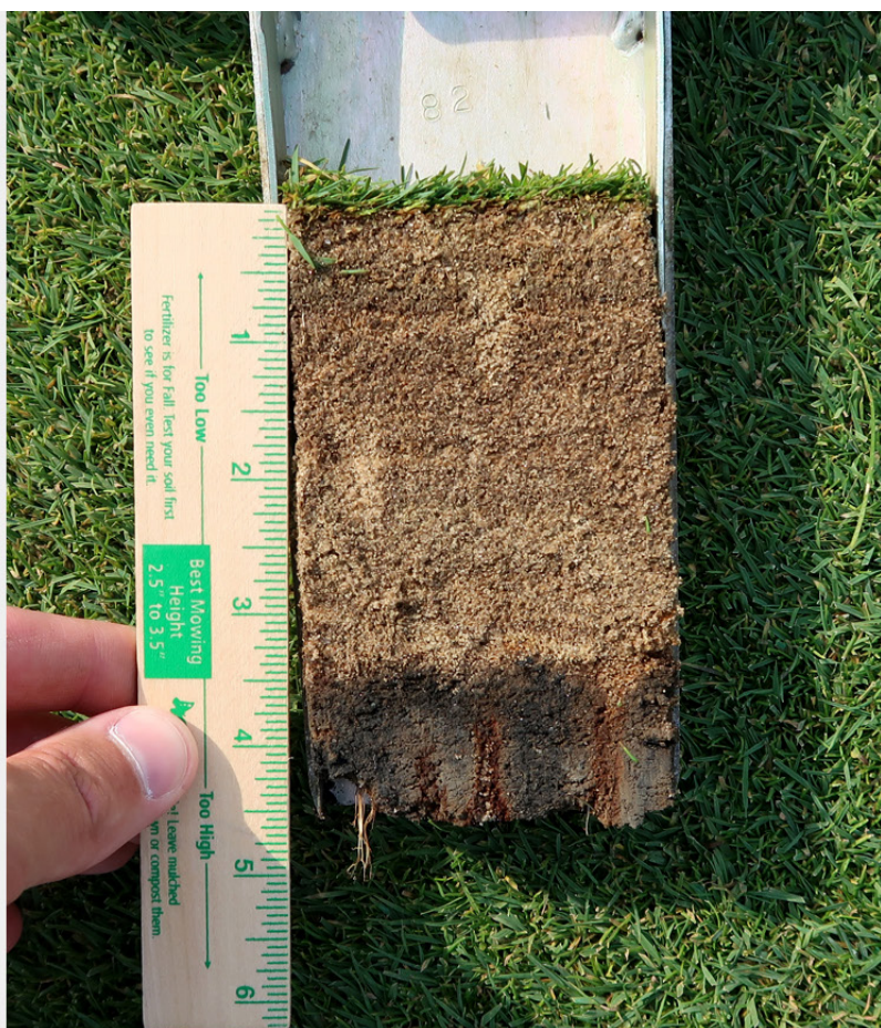
Godt blandede greens vækstlag - USGA (venstre) og forbedret push-up (højre) - fremmer sund rodudvikling og gode spilleforhold ved at lade vandet bevæge sig frit gennem profilen.
